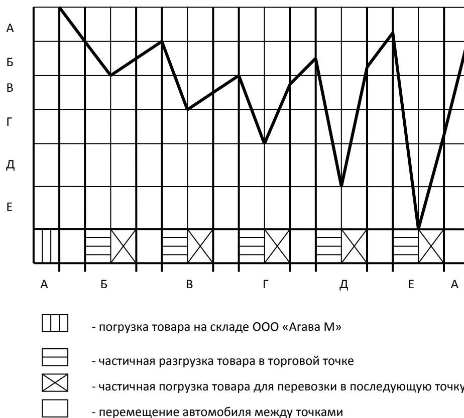
Рисунок 2.4 – Схема двухстороннего маятникового маршрута движения автомобилей
